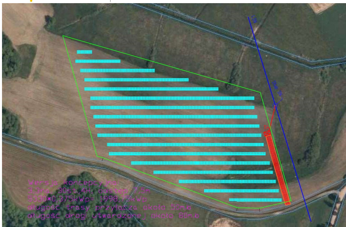
Rysunek 6 Wstępne rozmieszczenie poszczególnych elementów farmy fotowoltaicznej na tle mapy satelitarnej
