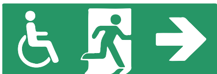
Ryc. 15.1. Symbol dostępnej drogi ewakuacyjnej (źródło ISO/FDIS 21542:2011)
