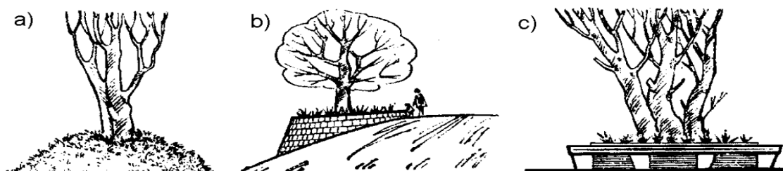
Rys. 2. Zabezpieczenie drzew przy obniżeniu terenu, po wykonaniu wykopów
